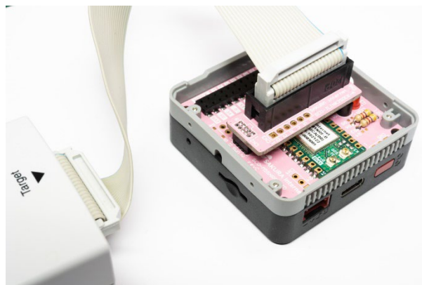
Figure 9 J-Link コネクタ変換基板を使用した接続
